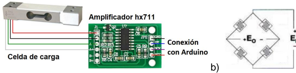
Figura 4. Hardware como solución con detalles de un sensor de peso.
