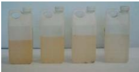
Figura 3.5. Coloración típica de los lixiviados obtenidos de las columnas testigo a las que se le aplicó agua de canales.
