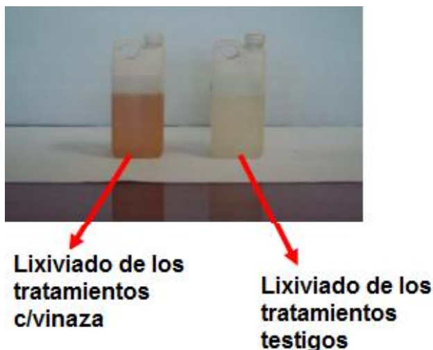
Figura 3.6 Comparación de las coloraciones finales típicas obtenidas entre tratamiento con vinaza Vs. testigo
